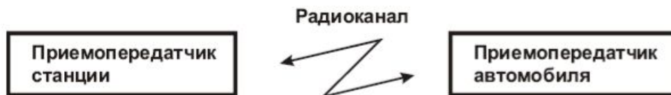
Рис. 9.44. Фрагмент системы мобильной телефонной связи
