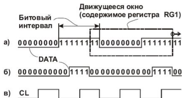
Рис. 9.24. Временные диаграммы, поясняющие принцип действия коррелятора: а - сигнал DATA без искажений; б - сигнал DATA с искажениями; в - восстановленный синхросигнал
