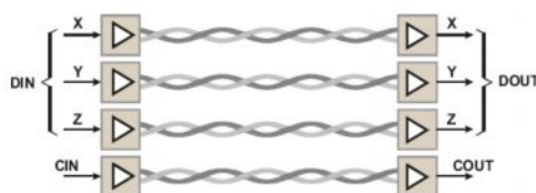
Рис. 3.18. Схема параллельной передачи данных и синхросигнала по витым парам проводов без применения кодирования
