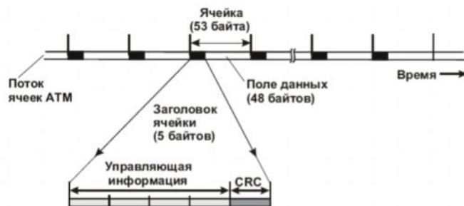
Рис. 9.42. Непосредственная передача ячеек ATM по линии связи
