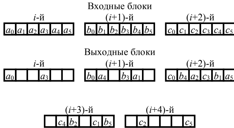
Рис. 5.3. Пример межблокового перемежения при B=3 и N=2
