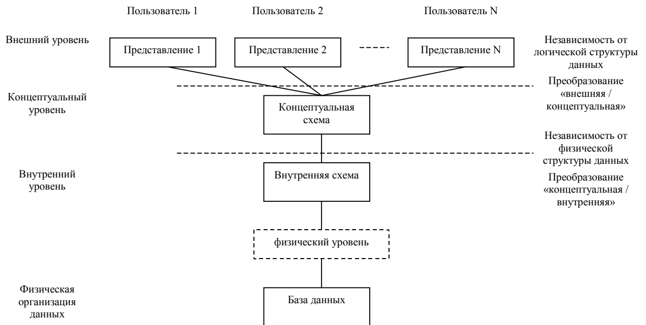
Рисунок 2. Трехуровневая архитектура ANSI-SPARC.
