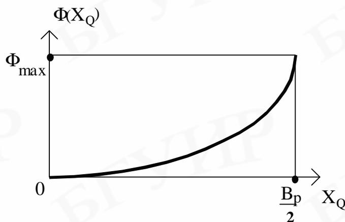
Рис. 20. Фазовое распределение поля на раскрыве рупора
