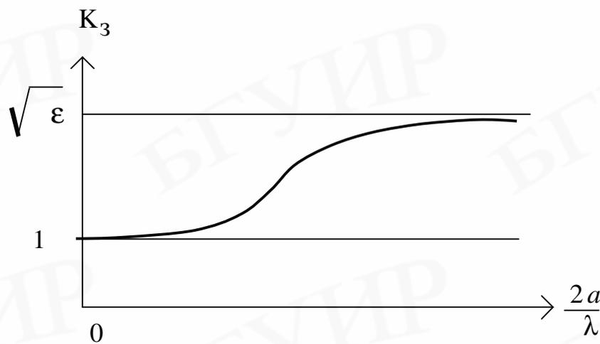
Рис. 51. Зависимость коэффициента замедления от волнового диаметра направителя
