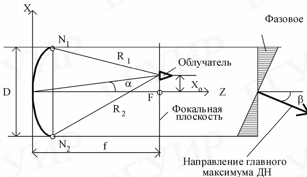
Рис. 34. Смещение облучателя из фокуса в фокальной плоскости
