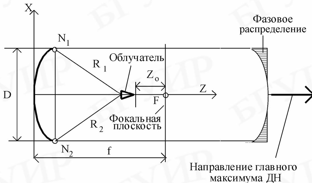
Рис. 35. Смещение облучателя вдоль фокальной оси
