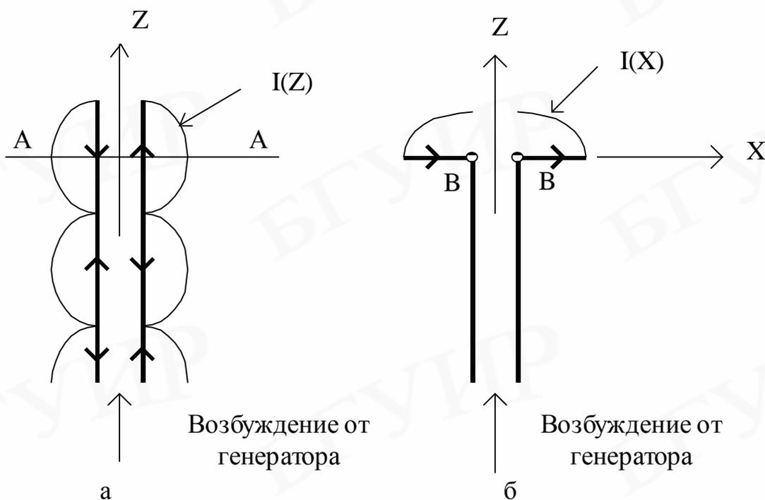
Рис. 8. Двухпроводная линия (а) и полуволновой вибратор (б)
