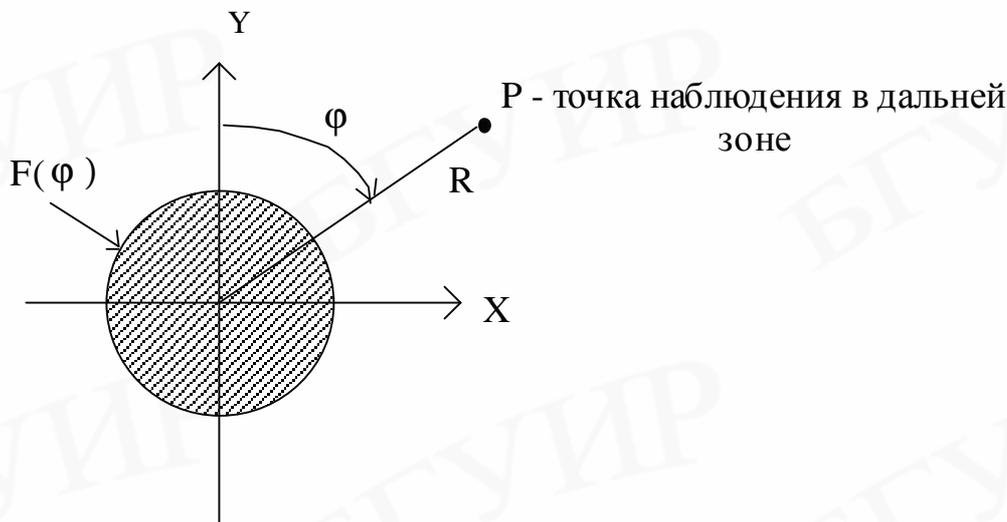
Рис. 10. Диаграмма направленности вибратора в плоскости H
