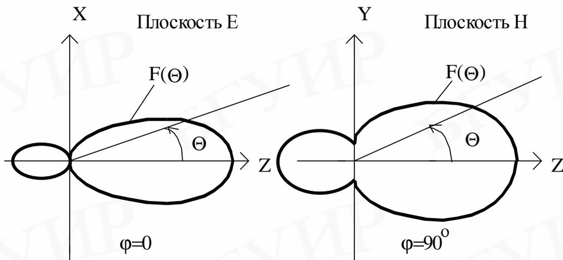
Рис. 12. Диаграммы направленности полуволнового вибратора с рефлектором
