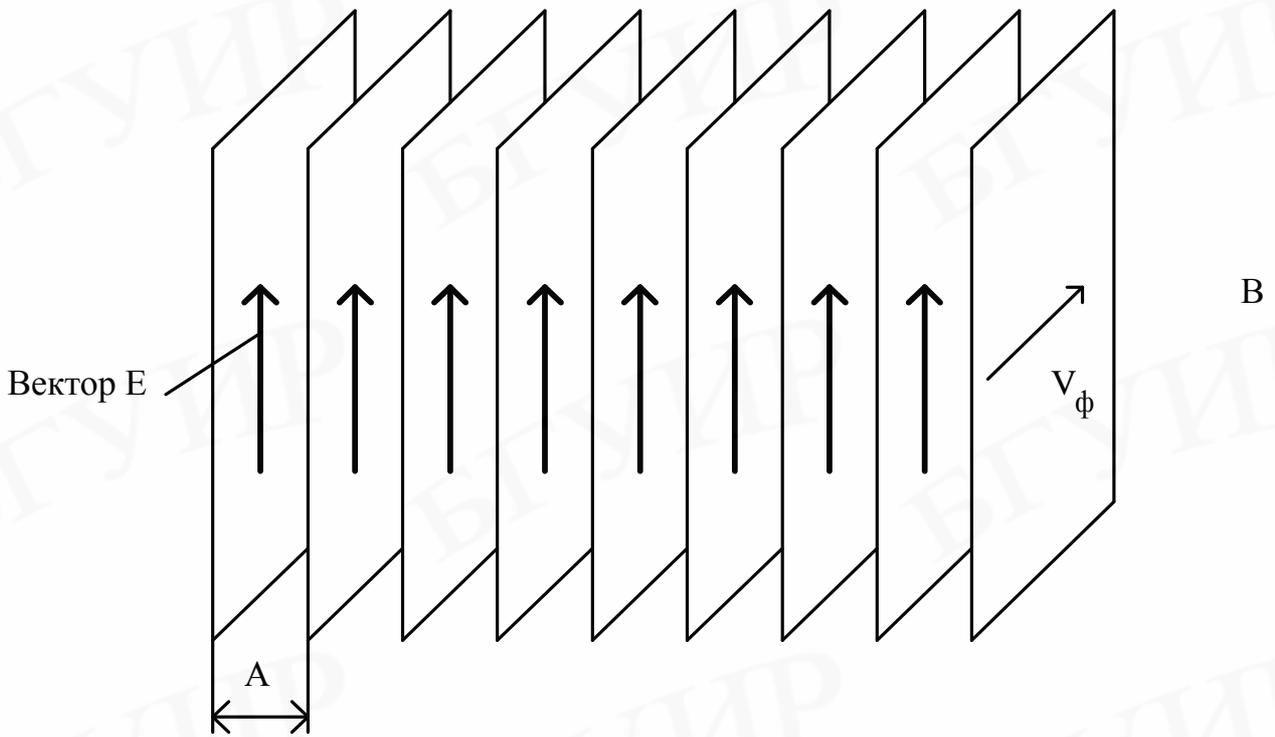
Рис. 28. Система плоских волноводов с  $V_\phi > c$  ( $n < 1$ )
