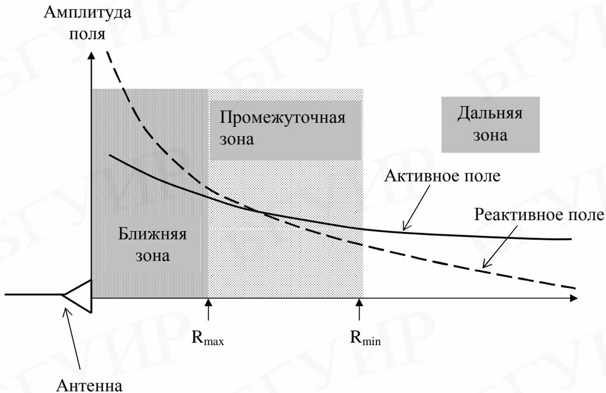
Рис. 2. Зависимость активного и реактивного поля от расстояния
