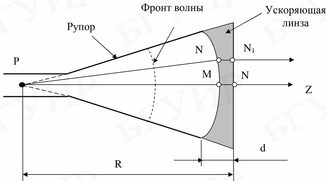
Рис. 25. Рупор с ускоряющей линзой
