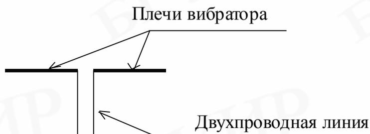
Рис. 7. Симметричный вибратор
