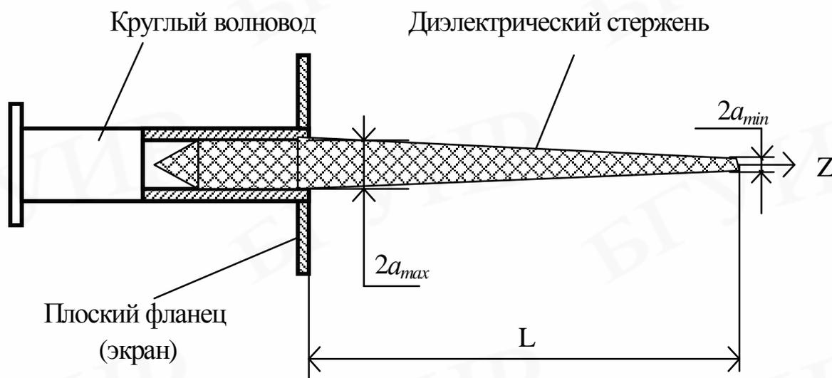
Рис. 49. Антенна бегущей волны с коническим диэлектрическим направителем
