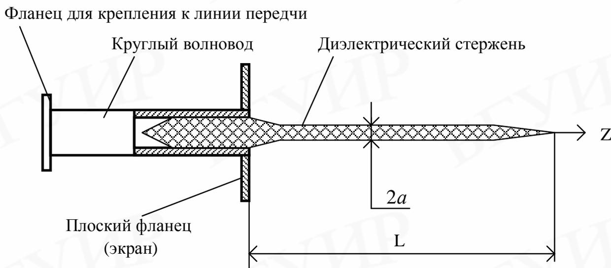
Рис. 48. Антенна бегущей волны с цилиндрическим диэлектрическим направителем
