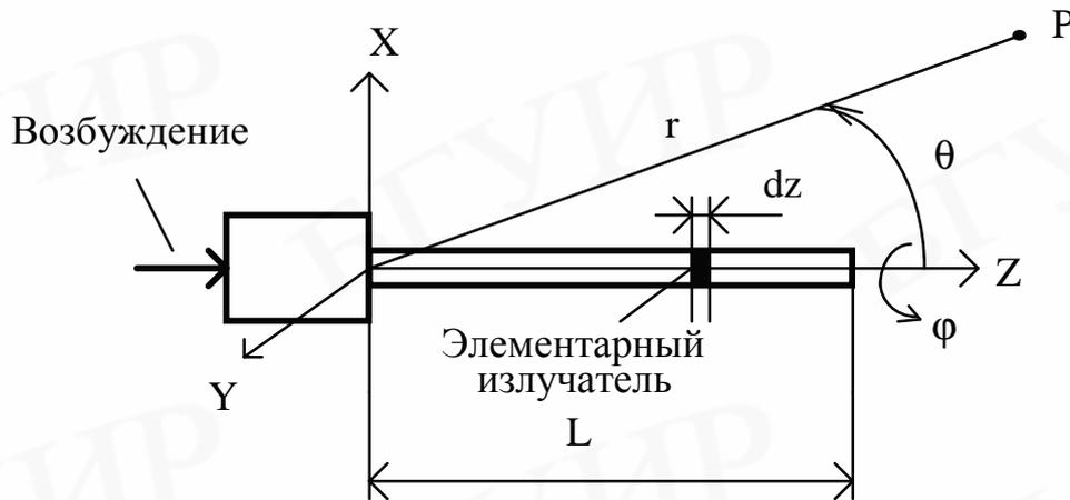
Рис. 46. Антенна бегущей волны в системе координат
