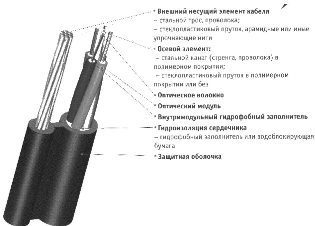
Рис. 13.30. Конструкция оптического кабеля ОКТ-6Д-А16-3,5
