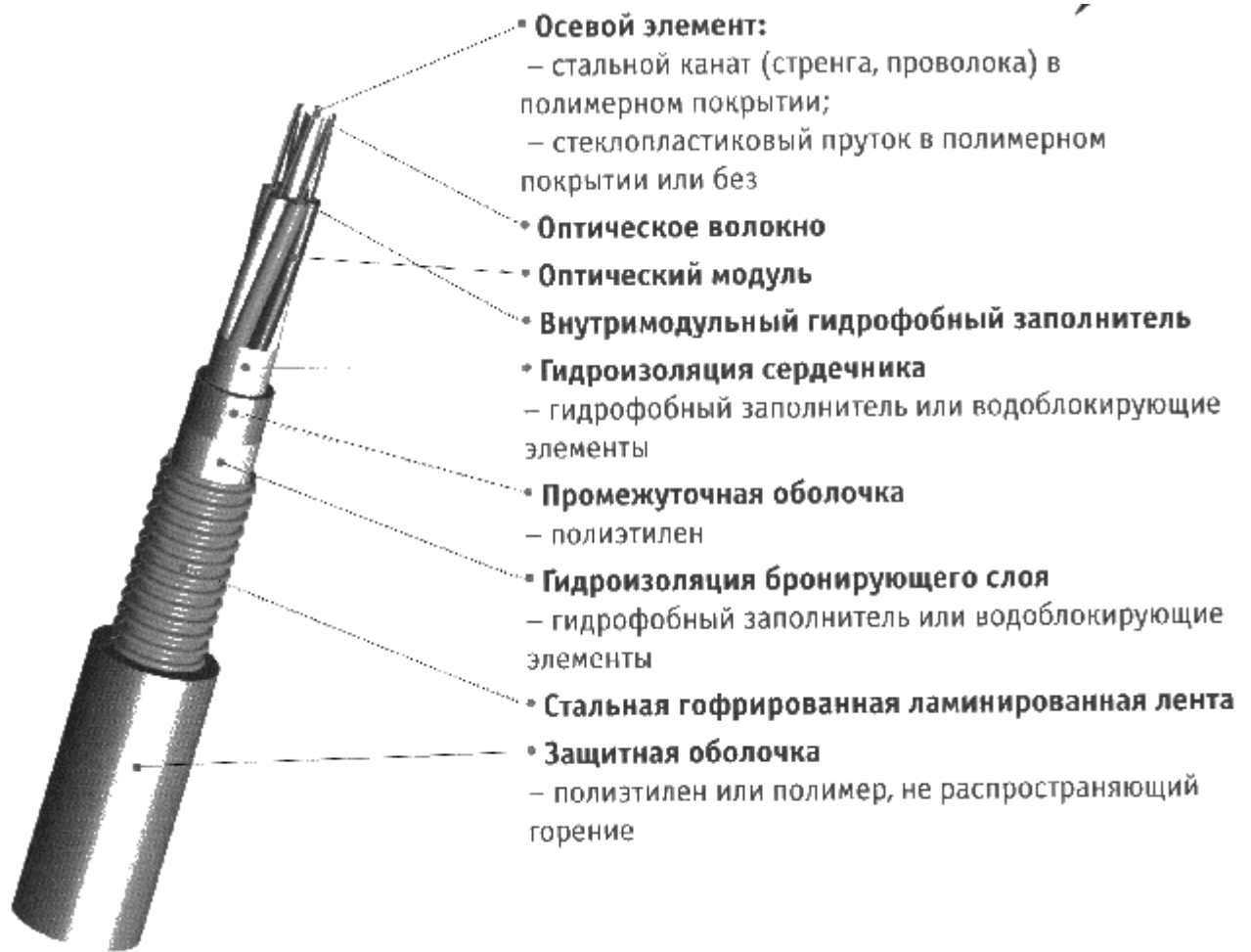
Рис. 13.28. Конструкция оптического кабеля ОКС-6Д-А16-3,5
