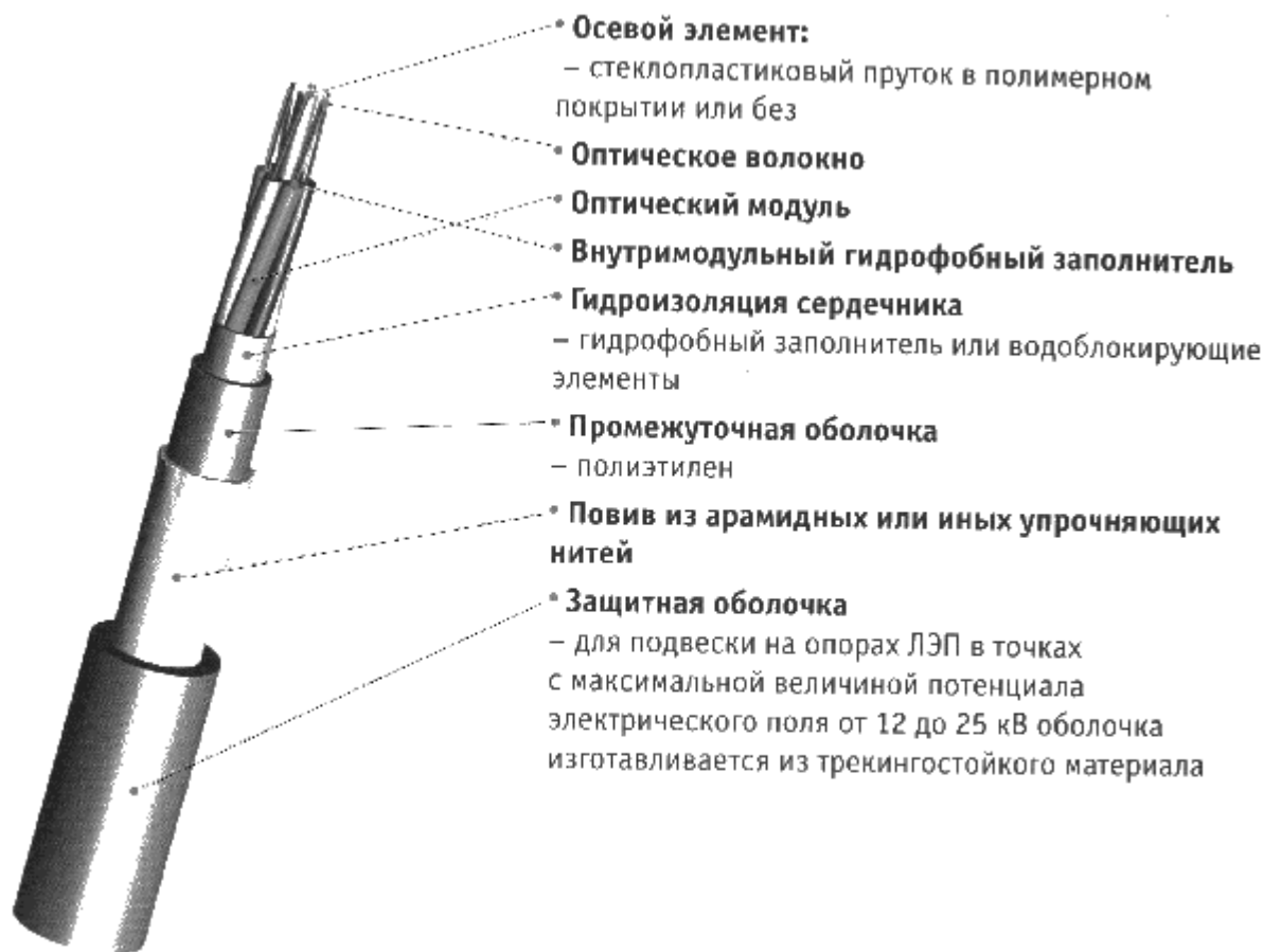
Рис. 13.31. Конструкция оптического кабеля ОКА-6Д-А16-3,5
