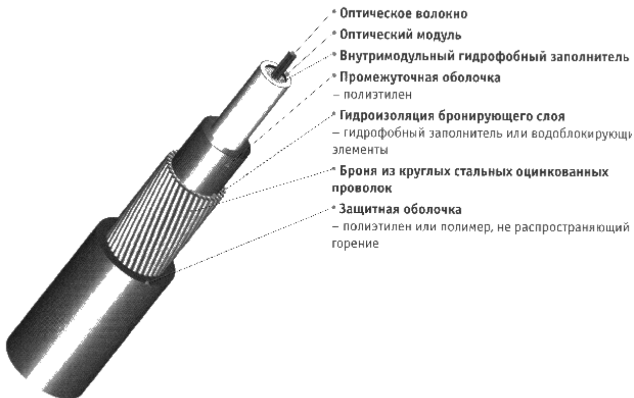
Рис. 13.27. Конструкция оптического кабеля ОКБ-Т-А12-3,5
