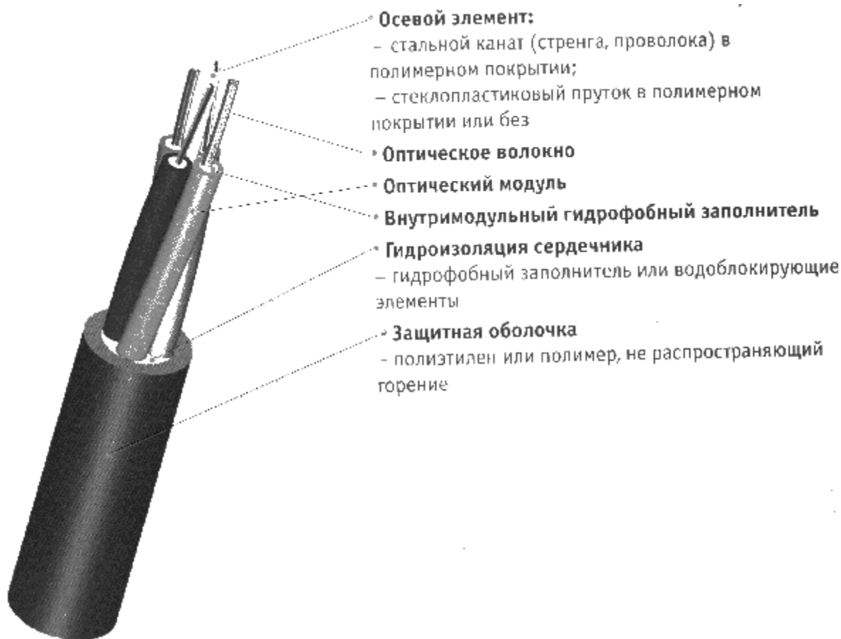
Рис. 13.29. Конструкция оптического кабеля ОК-6Д-А16-3,5
