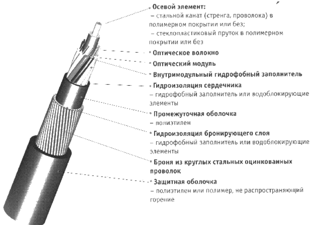
Рис.13.26. Конструкция оптического кабеля ОКБ-6Д-А16-7
