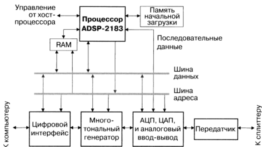
Рисунок 1.2 Структурная схема модема
