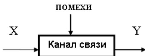
Рис. 7.2. Обобщенная схема канала связи.
