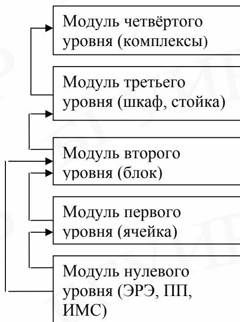
Рис. 3.1. Иерархия конструкционных систем
