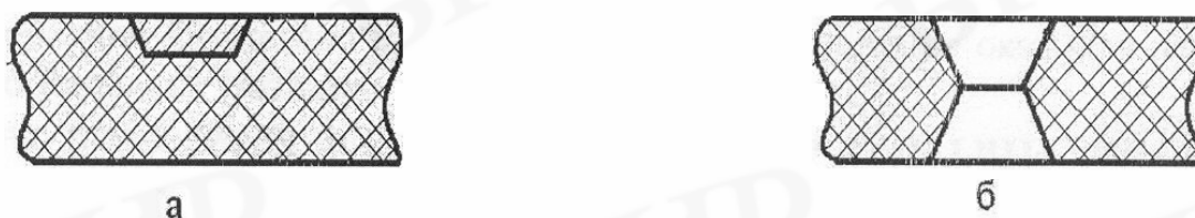
Рис. 4.4. Элементы рельефной платы: А – ПЕЧАТНЫЙ ПРОВОДНИК; Б – ОТВЕРСТИЕ
