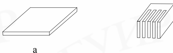
РИС. 6.49. КОНСТРУКТИВНЫЕ РАЗНОВИДНОСТИ РАДИАТОРОВ: А – ПЛАСТИНЧАТЫЕ; Б – РЕБРИСТЫЕ
