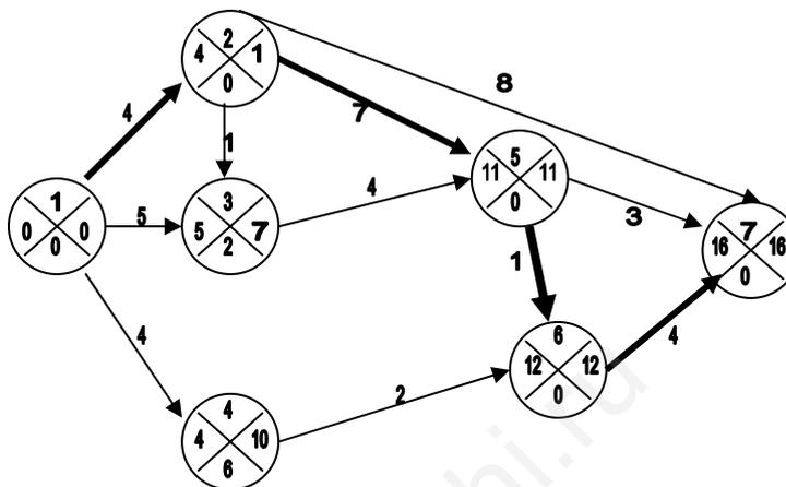
Рис.2.1. Сетевой график с характеристиками событий
