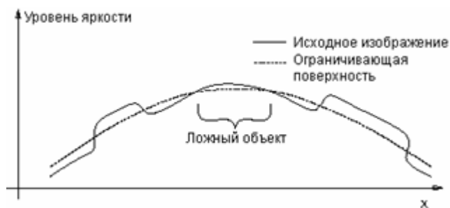
Рисунок 2. Возникновение ложных объектов при бинаризации.
