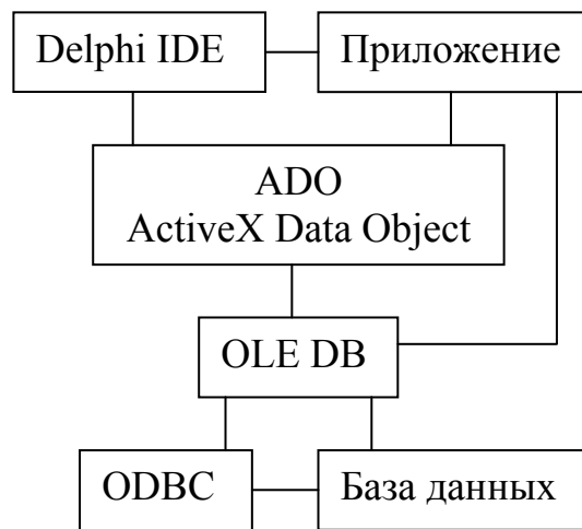
Рис.29.2. Схема взаимодействия с базами данных с использованием ADO
