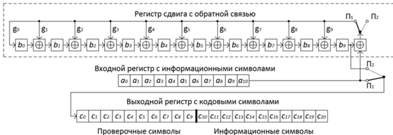
Рисунок 5 – Кодер систематического кода, задаваемый g(x)
